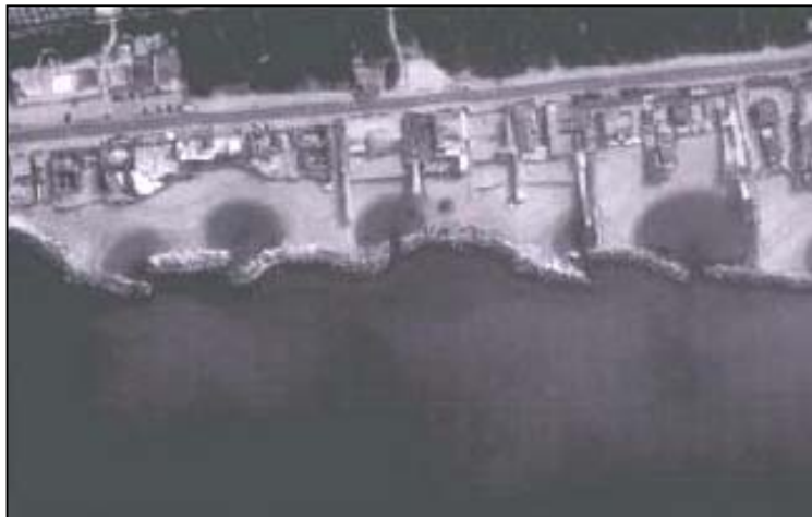
Fig. 8: Detached breakwaters at Marina di Massa.
